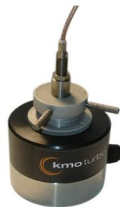
In einem kompakten Gehäuse befindet sich eine Scheibe aus typischem Wellenmaterial, die mit einem speziellen Schwingungsgeber fest verbunden ist.
