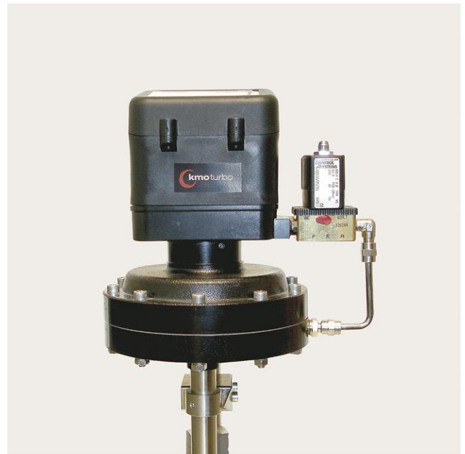
Verzögerungsfreie Reaktion, Schnellöffnung <0,5 sec mit kleinem Magnetventil und optimalem Regelverhalten beim Schlitzscheibenventil.
