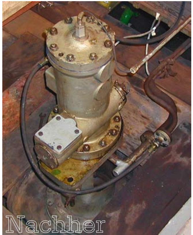
Neues Design: Keine mechanische Vorsteuerung, mit berührungsloser Wegmessung und Anschluss über Schläuche.
