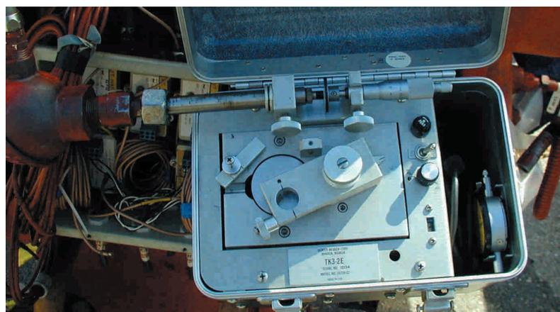
Obenstehendes Bild zeigt das weit verbreitete System TK3 der Fa. Bently Nevada. Derartige Systeme sind vergleichsweise schwer, unhandlich, teuer und berücksichtigen nicht den Messfehler, der durch abweichendes Wellenmaterial entsteht. Die Sonde muss für die Messung erst ausgebaut sowie auf dem Gerät montiert und justiert werden. Die Praxis hat gezeigt, dass die unsachgemäße De- und Remontage der Sonden die häufigste Ursache von Beschädigungen ist.
